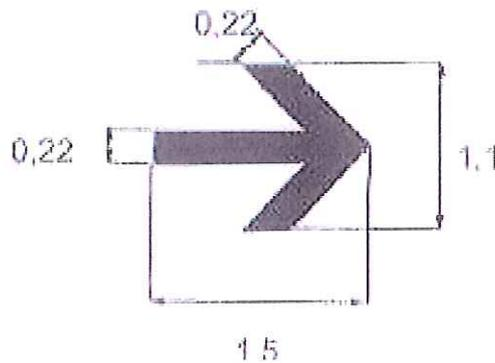
Les flèches obliques orientées à 45° vers le haut et vers la droite ou la gauche pour les mouvements concernés dans les carrefours en «Y» ou en présence d'une voie de décélération.
