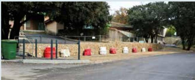
Un mur permet de limiter l'accès des véhicules aux abords de l'entrée, son habillage en pierre assure son intégration à l'environnement. Un revêtement de couverture devrait limiter les traces de ruissellement des eaux de pluies et... probablement servir de banc aux parents ! D'autres « potelets » métalliques amovibles au moyen d'une clé permettront l'accès des véhicules d'entretien, de livraison et de secours.
