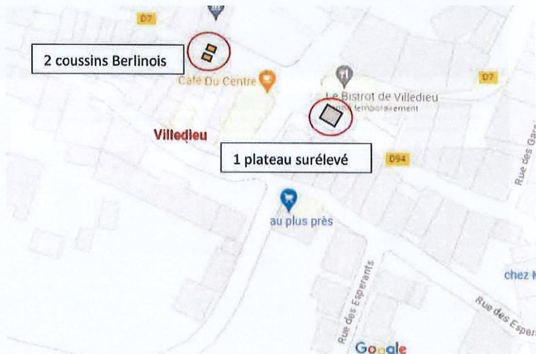
Côté mairie- RD 7 pose de deux cousins berlinois en béton mono bloc – intégration dans les bétons existants en respectant l'écoulement des eaux de pluies profil en V
