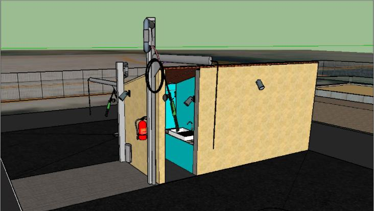
Commune de Villedieu Aire de remplissage lavage des pulvérisateurs agricoles avec traitement des effluents phytosanitaires
