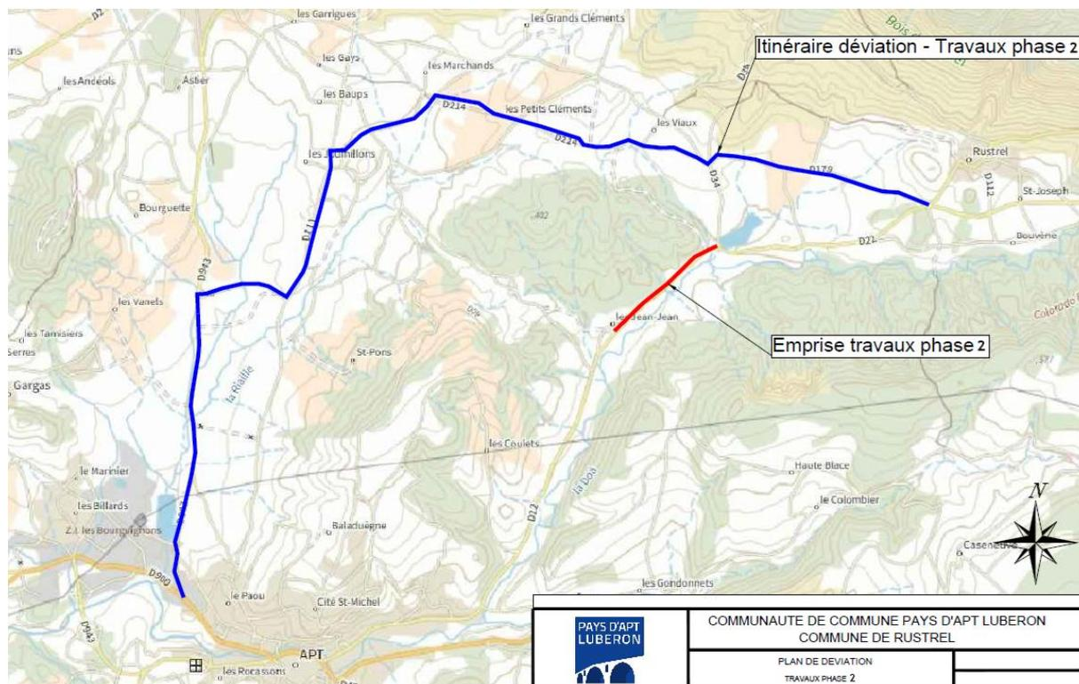
Les travaux sur l'emprise du rond-point de Rustrel seront réalisés pendant la phase 2, en demi chaussée via un alternat par feux tricolores.
